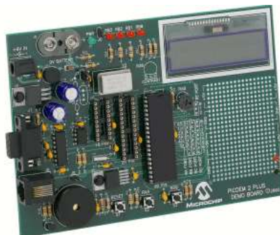
PICDEM2 PLUS – Placa de entrenamiento para microcontroladores PIC16/18
